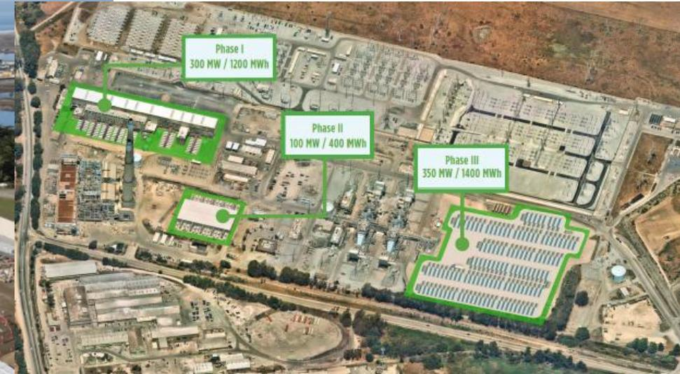
El sistema de baterías de litio más grande en California es la Moss Landing Energy Storage Facility, ubicada en Monterey Bay. Posee una capacidad de **750 MW de potencia y 3 000 MWh de energía** almacenada, tras su expansión completada en agosto de 2023. Ocupa parte del sitio de una antigua planta térmica
